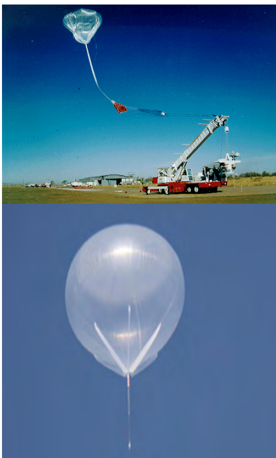
Figura 4. Globos estratosféricos portando instrumentación científica en su góndola antes del lanzamiento (arriba) y después (debajo).
